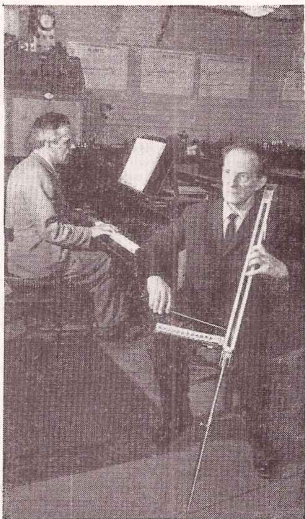
Очередное прибавление в семействе терменовоксов — новый смычковый электроинструмент. Л. С. Термен (на переднем плане) испытывает его в лаборатории музыкальной акустики и звукозаписи Московской консерватории.
