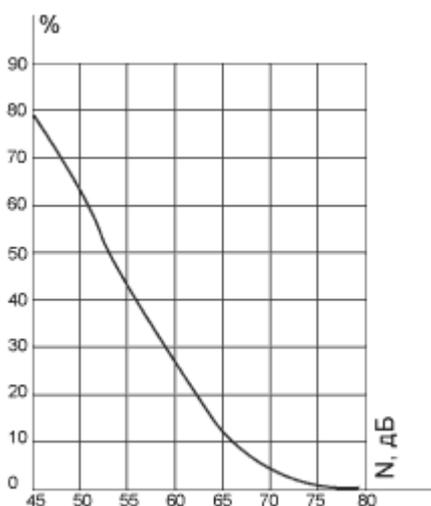
**Рис. 4.** Амплитудный состав речи в полосе 1000 - 1400 Гц
