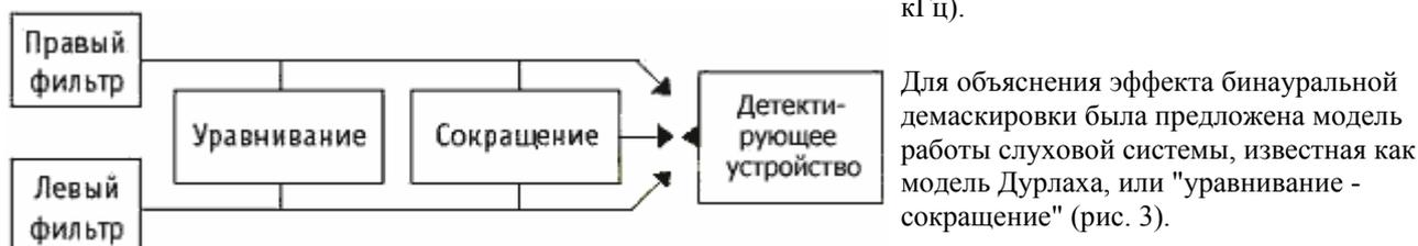
Рис.3 Структура модели "управление-сокращение"
