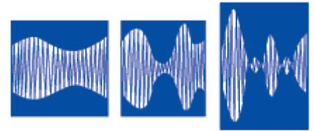
Рис. 1 Вид АМ-сигнала при разной глубине модуляции
