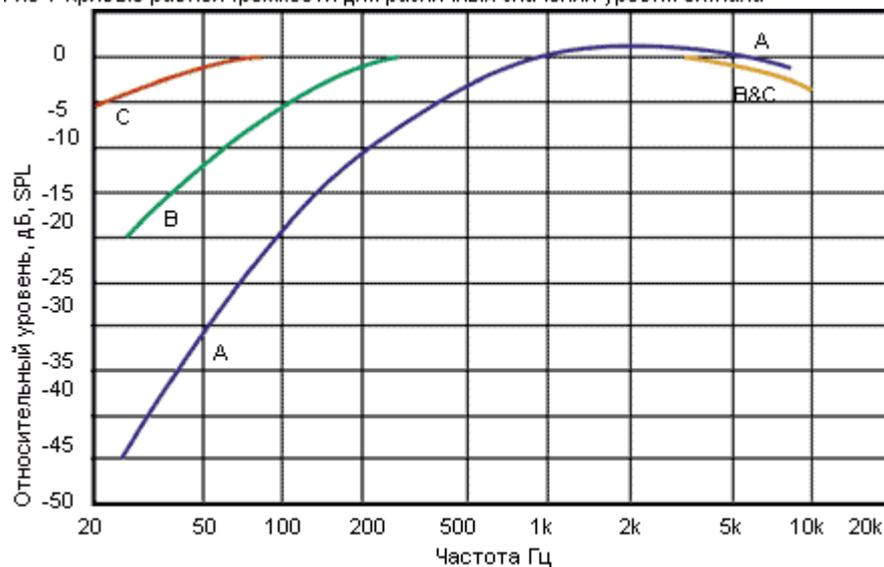
Рис 2 Взвешенные кривые А,В,С для измерения уровней шума
