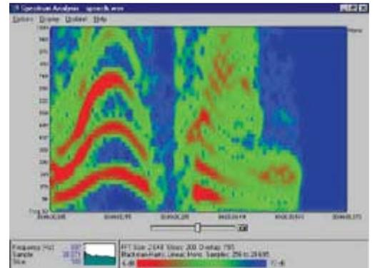
*Рис. 6. Спектрограмма речевого сигнала*
