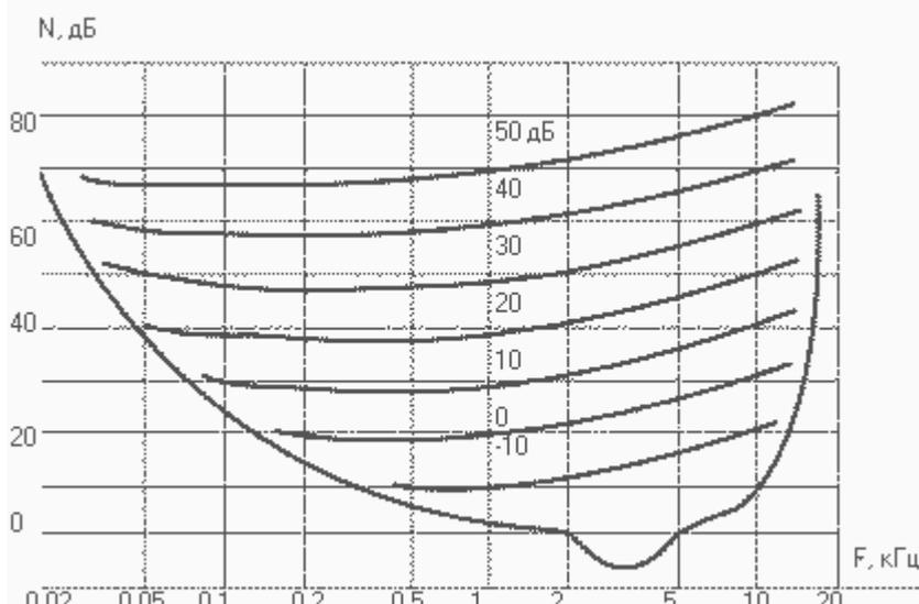
Рис 3 Кривые порога слышимости при маскировке белым шумом
