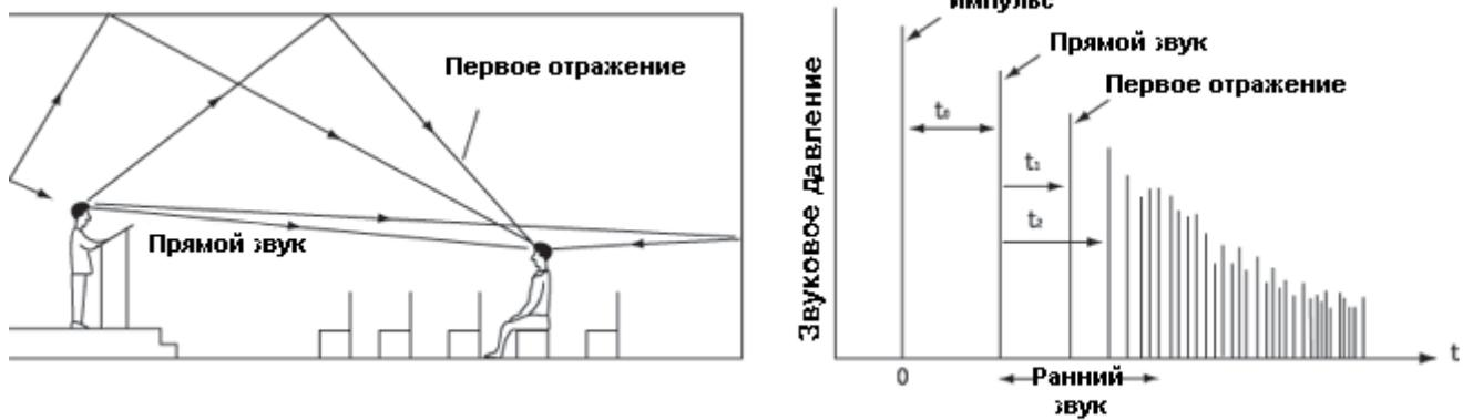
Рис.6 Структура отраженных сигналов в помещении
