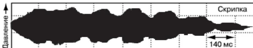
Рис.1 Временная структура и спектральный состав ноты С4 (до первой октавы), сыгранной на скрипке
