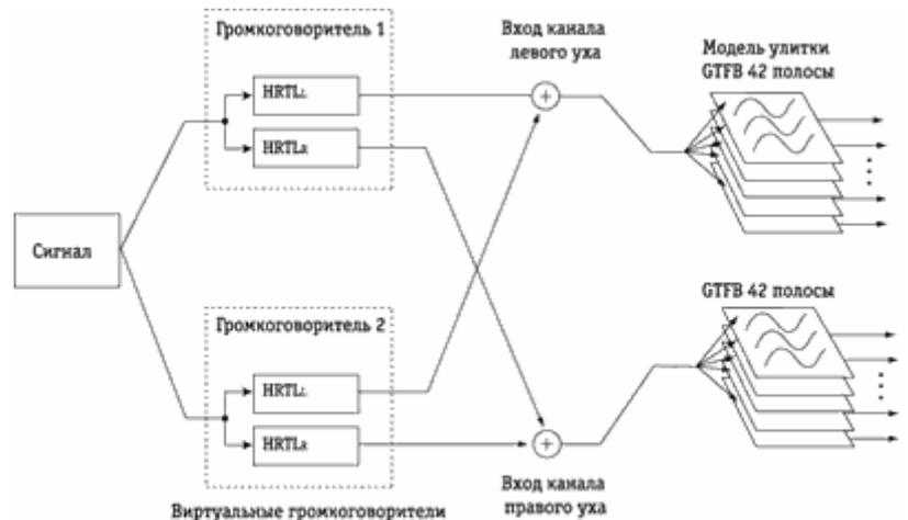
Рис.2 Принцип работы компьютерной слуховой модели
