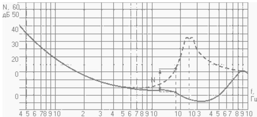
Рис 1 Кривая порога слышимости при маскировке чистым тоном
