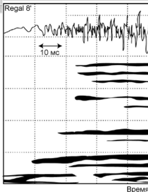
Рис.2. Атака звука для закрытой и открытой лабиальной
