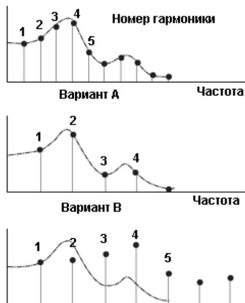
Рис. 8 Изменение огибающей спектра при сдвиге высоты
