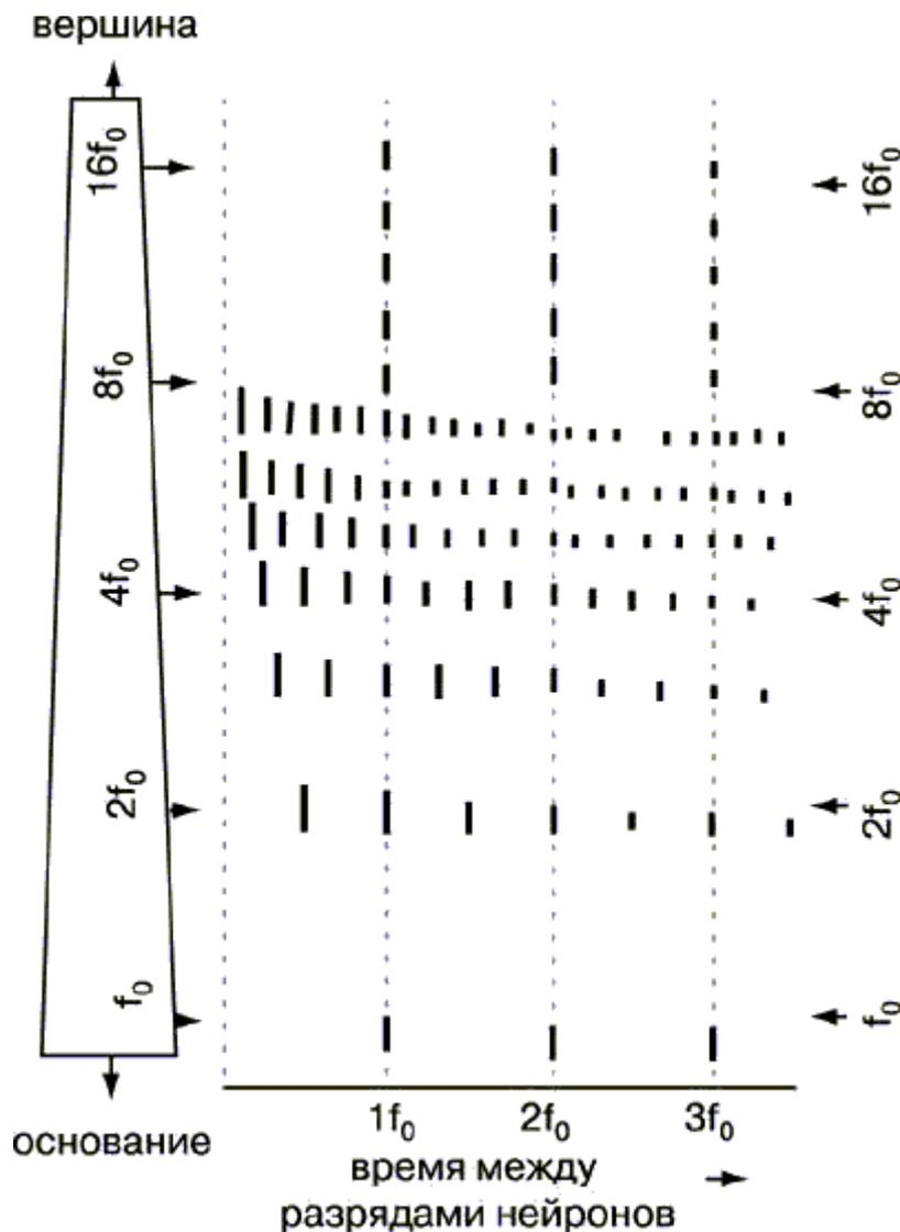
Рис 106 Периоды разрядов нейронов от разных мест базилярной мембраны
